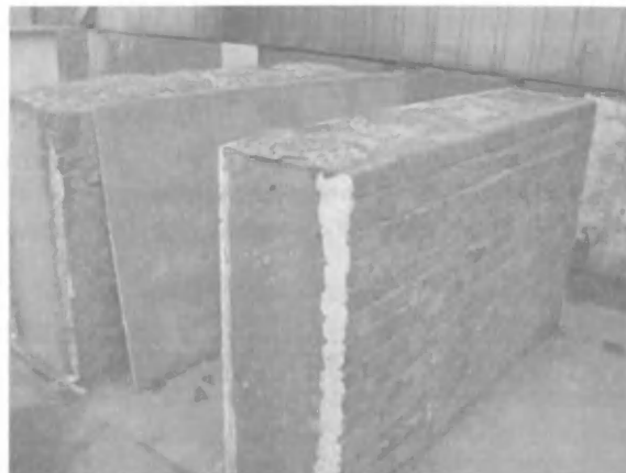
Рис. 5. Модифицированный пенобетон средней плотности 180 \text{ кг/м}^3 , возраст – 12 ч, залит в один прием, высота опалубки 1200 мм
