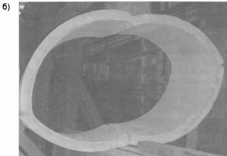
Рис. 5. Характер деформирования сталефиброшлакобетонного кольцевого элемента с разрушением ключевого сечения по схеме чистого изгиба
